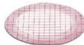
Белый фильтр из нитроцеллюлозы с черной сеткой, 0.45 мкм, стерильный, 6 мм гидрофобный край
